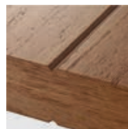
detailní záběr na frézování - viditelná struktura povrchu, úzké frézování
